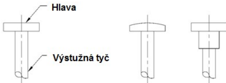
Obrázok 1 – Princiálna konštrukcia výstužných tyčí s hlavou s rôznymi geometriami hlavy
